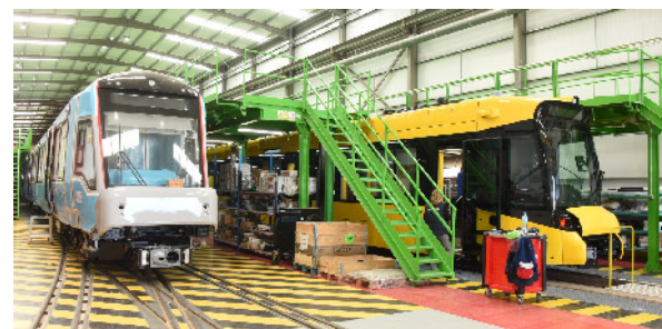
Endmontage der CITYLINK und TRAMLINK in Valencia: Links im Bild Transport for Wales/UK, die 36 bimodale Einheiten des CITYLINK bestellten. Rechts BLT-Waldenburger Bahn/CH, die letzte von deren zehn TRAMLINK-Einheiten.
