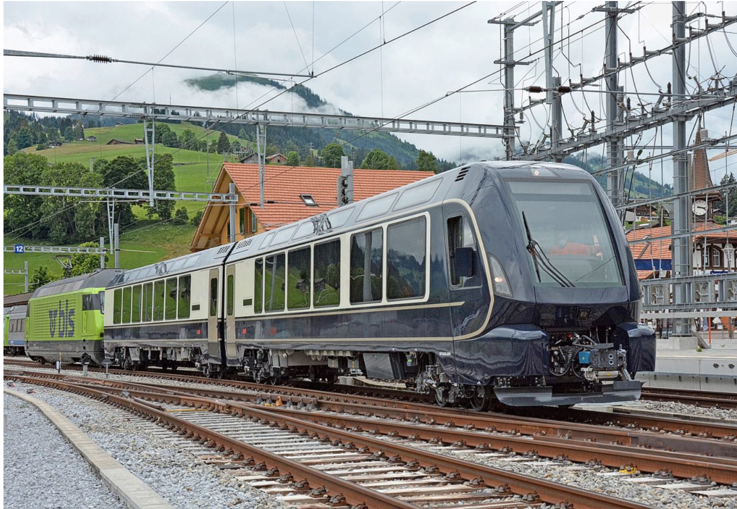
Der umspurbare Testzug verlässt erstmals den Bahnhof Zweisimmen Richtung Boltigen. Foto: Guido Lauper
