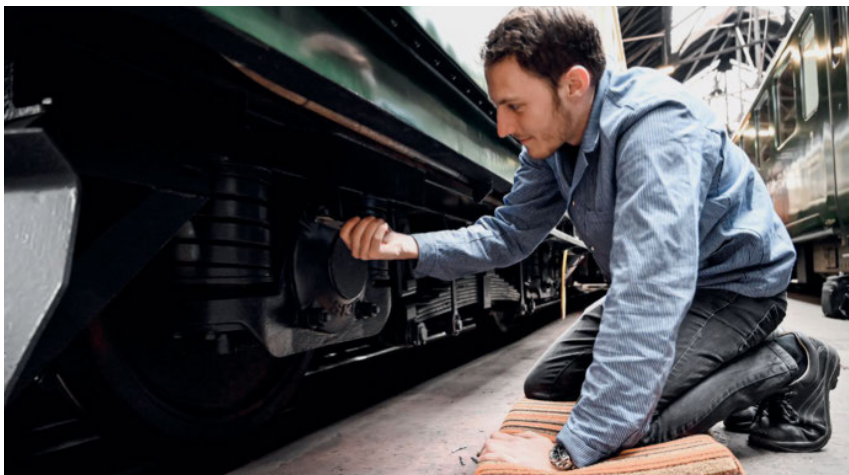
Ricardo Keller beim Entfernen der Achslagerabdeckungen im Lokorama in Romanshorn.
