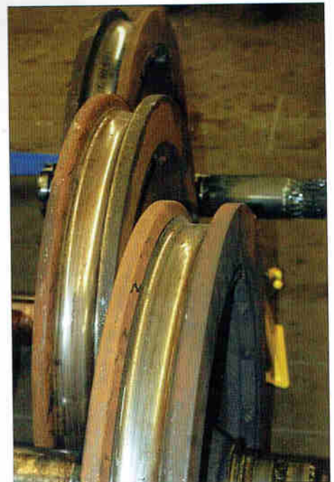
Die Räder der Wuppertaler Einschienebahn weisen zwei Spurränze auf. Aufnahme: Peter Bosbach
