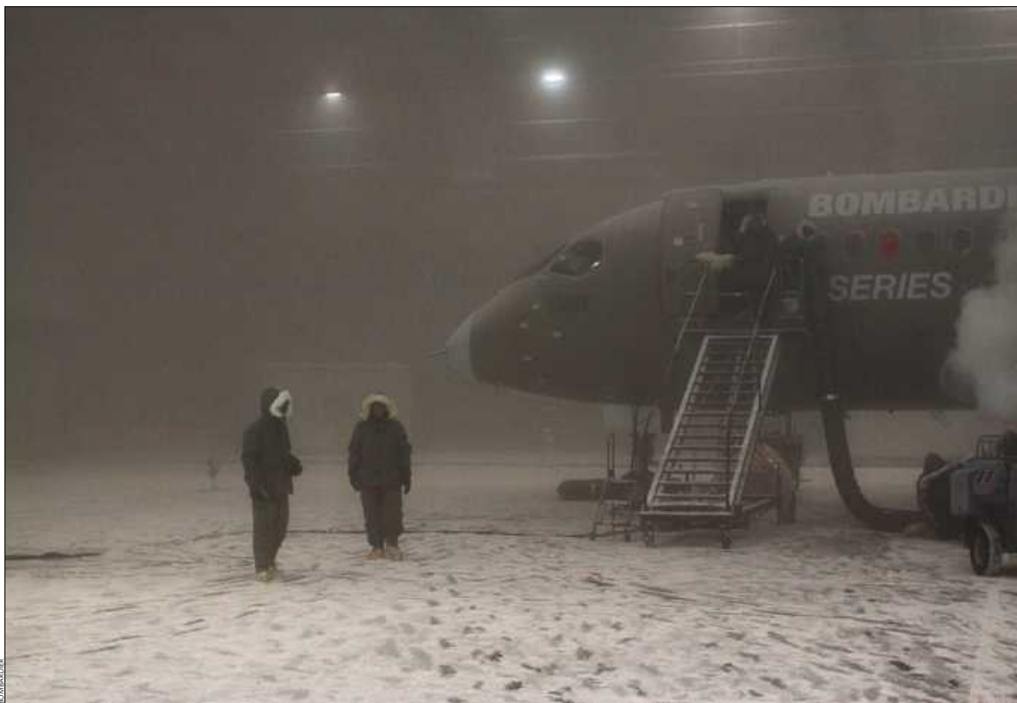
Construit au Canada, le nouvel appareil subit des tests de résistance aux températures extrêmes (jusqu'à -54 °C) au laboratoire climatique McKinley d'Églin, en Floride. ARCHIVES
