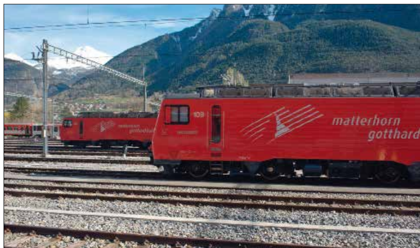
Ci-contre : les HGe 4/4 II 103 et 109 de la MGBahn stationnent sur le faisceau de Glisegrund. Ayant bénéficié d'une rénovation complète, ces engins sont devenus plus puissants et demeurent très appréciés de l'exploitant (27 mars 2024). Ci-dessous : plan de voies du site et la façon dont est utilisé le système TrackOps Depot.
