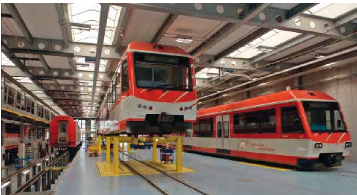
ABDeh 4/8 2026 en position « levée » et BDeh 4/8 2051 « Castor ». Cette automotrice sert aux navettes Täsch - Zermatt, aux côtés des 2052 (Pollux), 2053 (Albatros) et 2054 (Eagle) (Ateliers de Glisergrund, 27 mars 2024).
