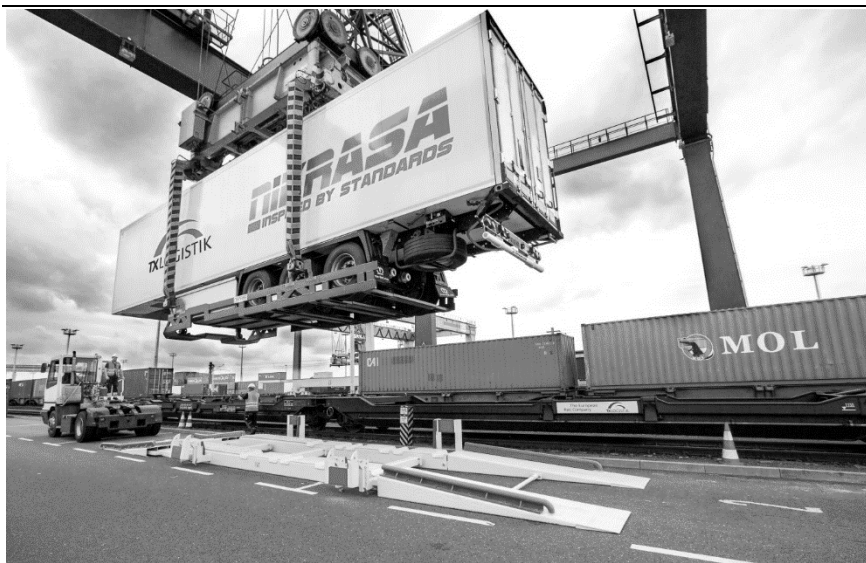
Abbildung 11: Das NiKRASA Verladesystem für Standardsattelaufleger
