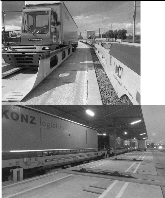
Abbildung 8: Verlad von Standardsattelaufleger mit dem System CargoBeamer
