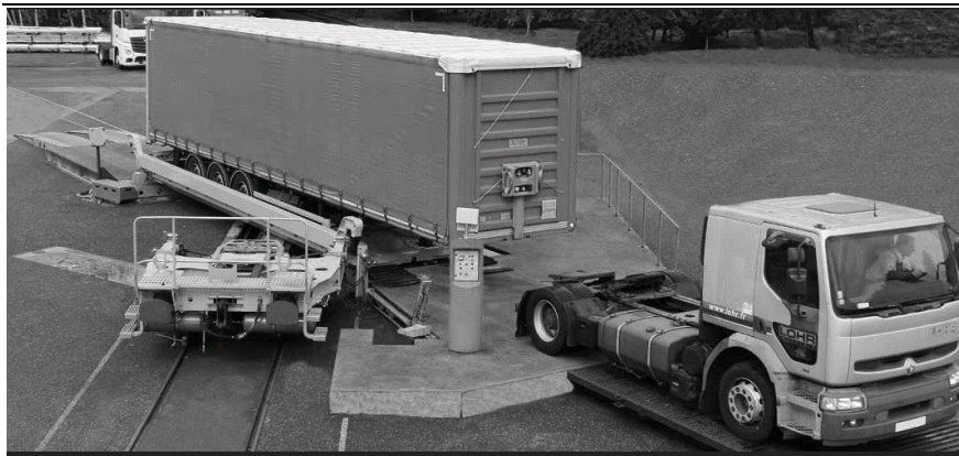
Abbildung 9: Belad eines Lohr-Tragwagens mit einem Standardsattelaufleger
