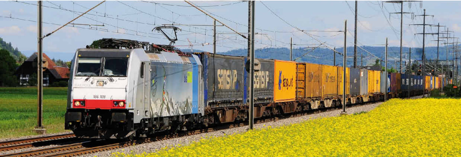
In 21 Stunden Fahrt mit 3 Stunden Pause von Rotterdam in die italienische Industrieregion Melzo: Das ist dank der durchgängigen Korridorfahrt mit einer Mehrsystemlokomotive seit Ende 2013 möglich.
