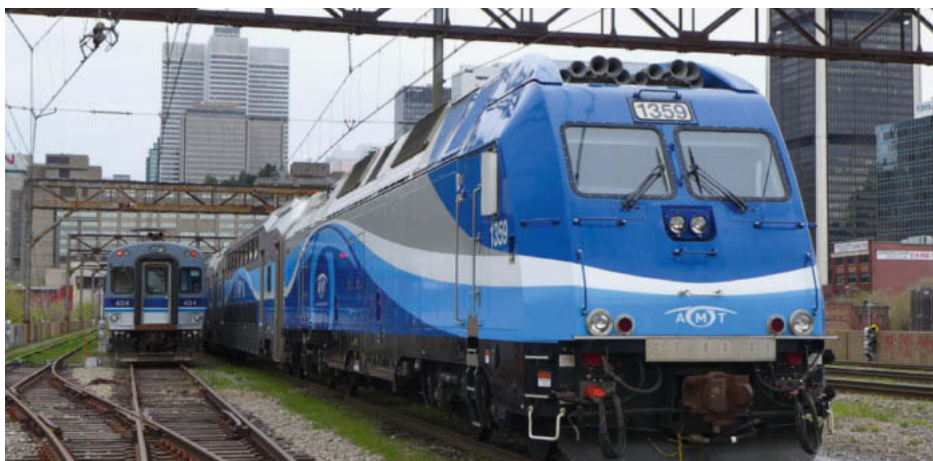
In Zürich entwickelt: Die Hybridlokomotive ALP-45DP im Vorbahnhof von Montreal. 20 solche diesel-elektrische Maschinen stehen seit 2011 im Dienst der Agence métropolitaine de transport, eingesetzt für den Vorortverkehr.
