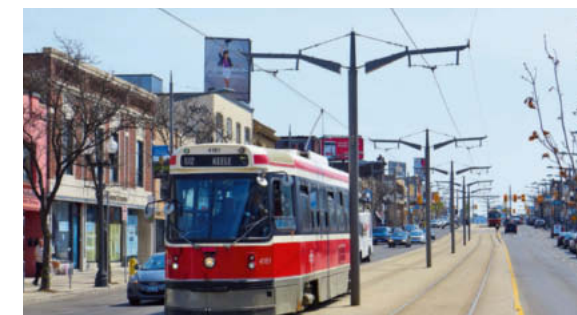
Ein älterer «Streetcar» am Stadtrand von Toronto: Die Fahrleitungsaufhängung wurde von Kummeler+Matter entwickelt. Die leichte, günstige Bauweise ist bei uns nicht üblich.
