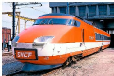
Der Prototyp TGV001 erreichte von 1972 bis 1978 mehr als 200-mal über 300 km/h, doch sein Gasturbinenantrieb war zu teuer.
