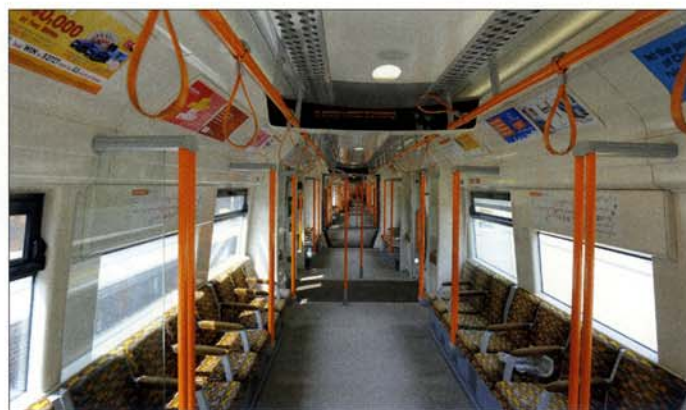
Die 4- oder 5-teiligen 57 Electrostar Triebzüge von Bombardier der Baureihe 379 wurden zwischen 2009 und 2012 in Dienst gestellt. Das Innere gleicht eher einem U-Bahn-Zug. Ausschliesslich Längssitze und breite Wagenübergänge. © Foto: Jürg D. Lüthard
