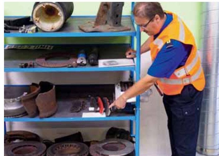
Stefan Simmen, der Leiter des SVZ, zeigt defekte Stoßdämpfer bis hin zur gebrochenen Bremscheibe.
