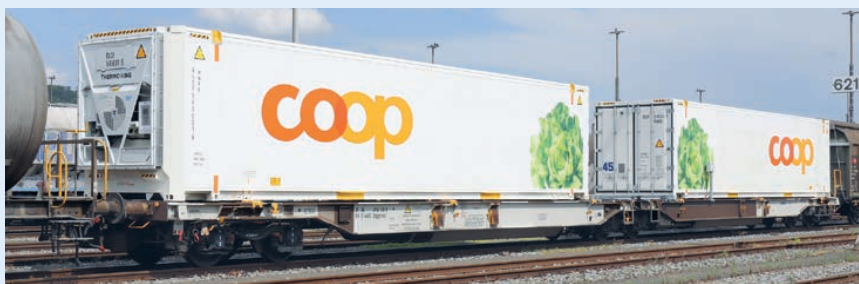
AAEC-Sdggmrss 37 80 4956 550 mit den beiden Pilot-Containern und der Überfahrplattform dazwischen. RBL, 16.5.2022. Foto: C. Ochsner
