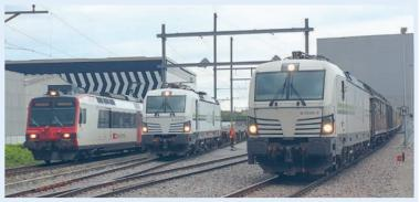
Vectron beim Rangieren im thermischen Betrieb auf dem Anschlussgleis des Coop-Logistikzentrums Schafisheim beim Bahnhof Hunzenschwil am 8.10.2021. In der Mitte stellt die Rem 476 456 die Sggmrss des Zuges 50884 aus Chiasso zu, rechts hat die Rem 476 454 die Hbbillns für den Zug 50662 nach Wangen bei Olten zusammengestellt. Links fährt ein SBB-Domino RBDe 560 als S28 Lenzburg–Zofingen vorbei.
