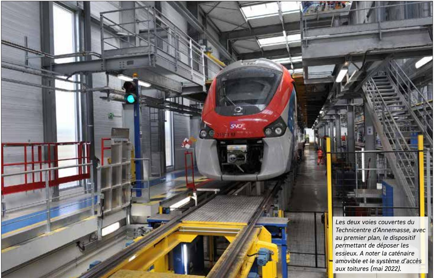
*Les deux voies couvertes du Technicentre d'Annemasse, avec au premier plan, le dispositif permettant de déposer les essieux. A noter la caténaire amovible et le système d'accès aux toitures (mai 2022).*
