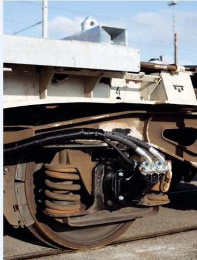
An der Achswelle angeschlossene Hydraulikpumpe.
