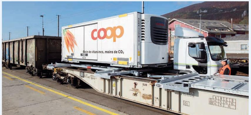
Horizontalumschlag eines elektrisch gekühlten Wechselbehälters mit dem System «Containermover 3000» auf einen AAEC-Sggmrs. Oensingen, 27.10.2016.
