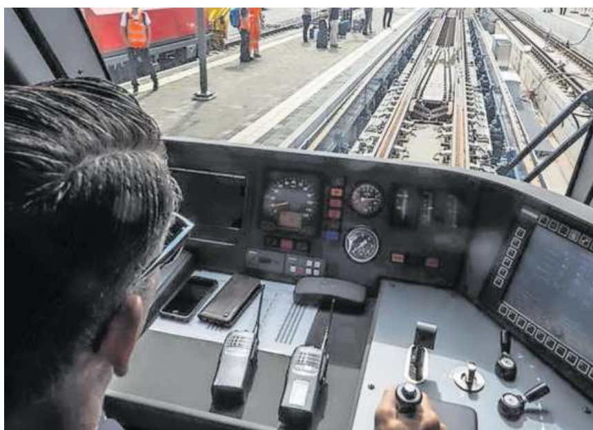
Fahrt über die Umspuranlage auf dem Vierschienengleis in Zweisimmen.
