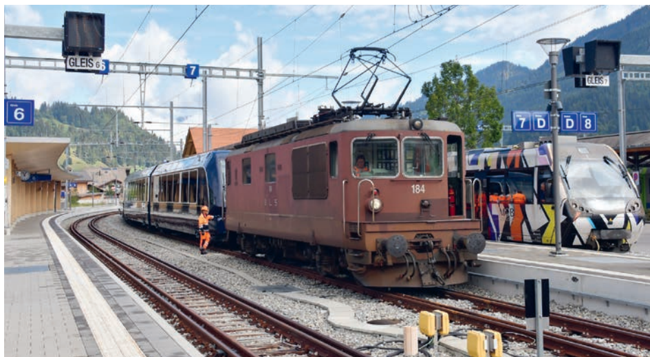
Zum Test der Hilfskupplung in Zweisimmen und aufgrund der für Messfahrten benötigten Re 465 wurde am 31.8.2022 die Re 425 184 am GPX eingesetzt. Rechts der MOB-ABt 341 als Teil des «Monarch». Oben links und rechts die Signale mit der Anzeige der Fahrleitungsspannung.
