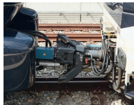
Die leicht geneigten Schwabkuppungen zwischen dem ABst 384 im Normalspurmodus und der (schmalspurigen) Ge 4/4 8004. Zweisimmen, 7.9.2022.
