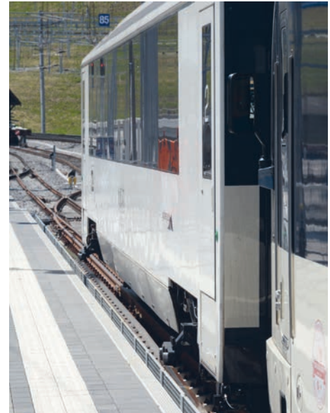
Während des Umspurvorgangs rollt der Wagenkasten mit den Laufrollen des Rollenschlittens am Schwenkarmsystem der Traverse auf den geneigten Laufbahnen der Umspuranlage.
