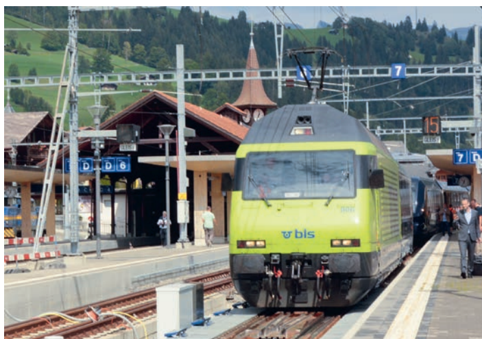
Die Re 465 006 fährt mit dem Bsi 291 über die Umspuranlage (mit horizontal gelegten Laufbahnen) in den Normalspurstumpen. Zweisimmen, 7.9.2022. Fotos: S: Freij
