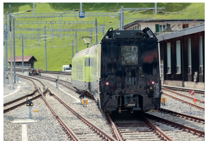
Die Re 465 006 fährt mit dem Bsi 291 über die Umspuranlage (mit horizontal gelegten Laufbahnen) in den Normalspurstumpen. Zweisimmen, 7.9.2022. Fotos: S: Freij
