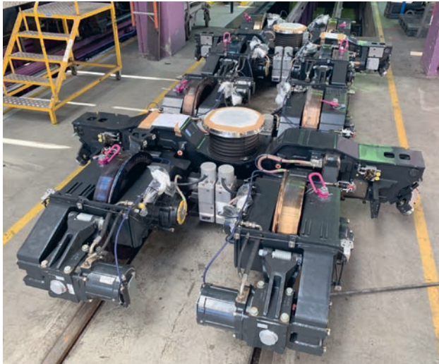
Die Vorserien-Drehgestelle EV18 auf einem Meterspurgleis. bei Stadler 23 Wagenkasten. Chernex, 30.1.2019.
