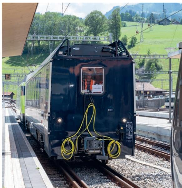
Accostage d'une Bsi et d'une Re 465 sur une Ast. Les tuyaux jaunes servent à arroser les surfaces de roulement pour les tests de glissement. Zweisimmen, le 29.6.2022. Photo: J. Bolliger
