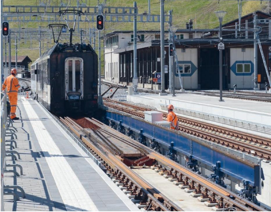
Démonstration de l'installation de changement d'écartements à Zweisimmen, le 1.5.2019, avec l'ABe 4/4 9303 (à voie métrique) et la Bs 221 dotée de bogies EV18 de présérie. La caisse de la voiture est soulevée en venant de la voie étroite, ensuite les tenons de conduite du système hydraulique côté bogie se crochent sur les quatre supports, et les roues roulent sur les boudins en direction de la voie normale.
