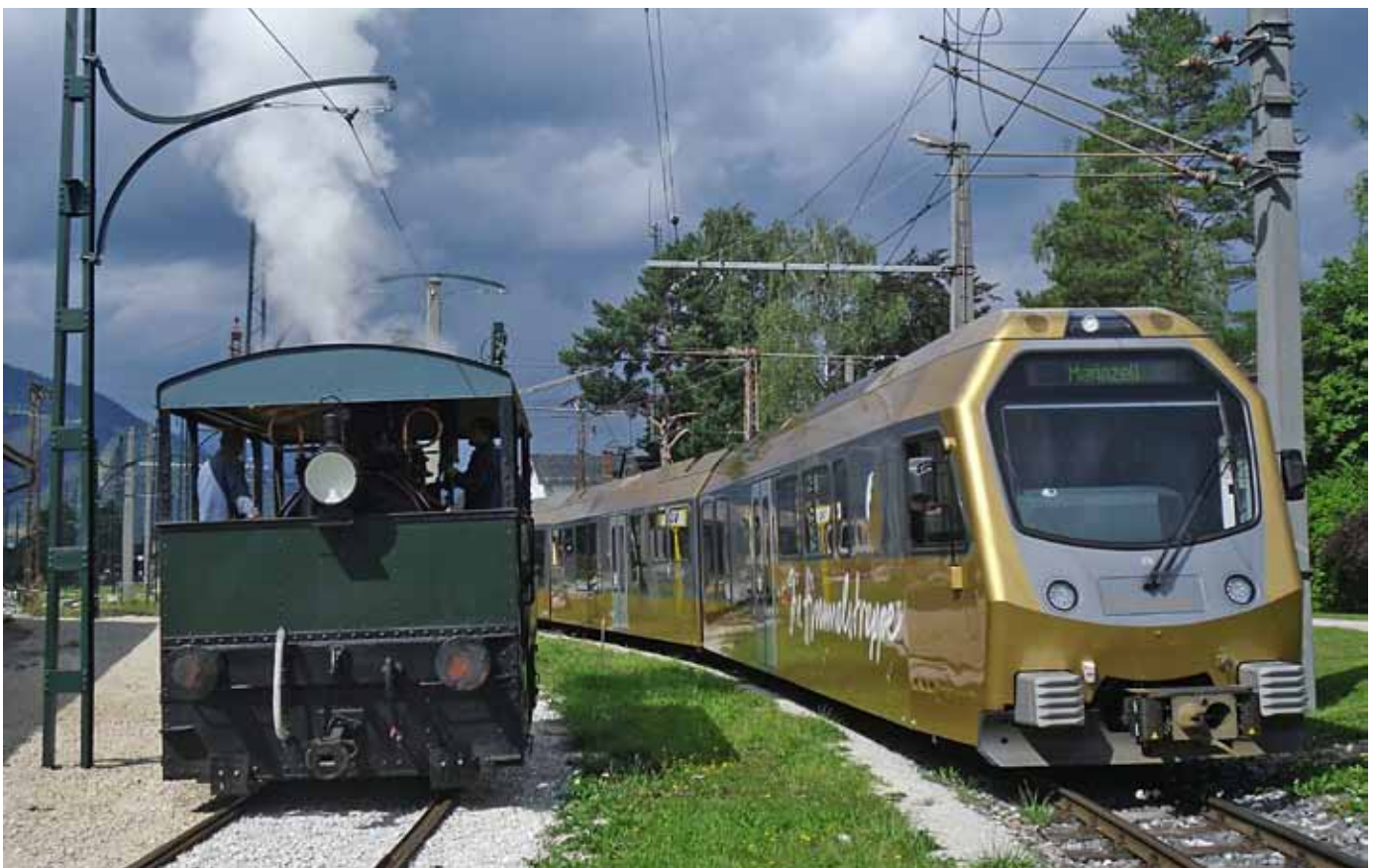
110 Jahre technische Entwicklung – links Lok 11 „Hellbrunn“ der Salzburger Lokalbahn auf Normalspur, rechts Himmelstreppe ET 6 + ET 1 der NÖVOG auf 760 mm im Bahnhof Mariazell.
