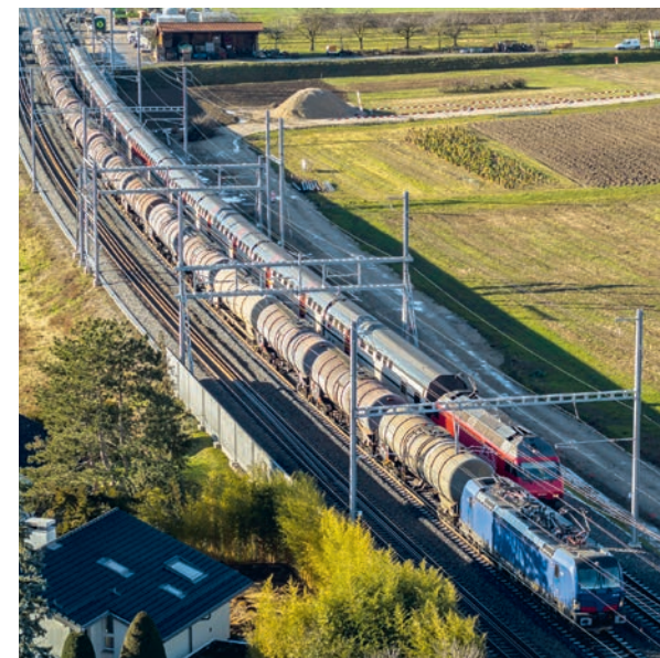
Der um einen B gekürzte DS IC-Pendelzug mit der Re 460 060 als IC 715 Genève-Aéroport–St. Gallen überholt den WRSCH-Ganzextrazug 69625 (Vernier-Meyrin Cargo–)Genève-La Praille–Rothenburg mit der von HUPAC gemieteten 193 492 und 18 vollen Kesselwagen.
