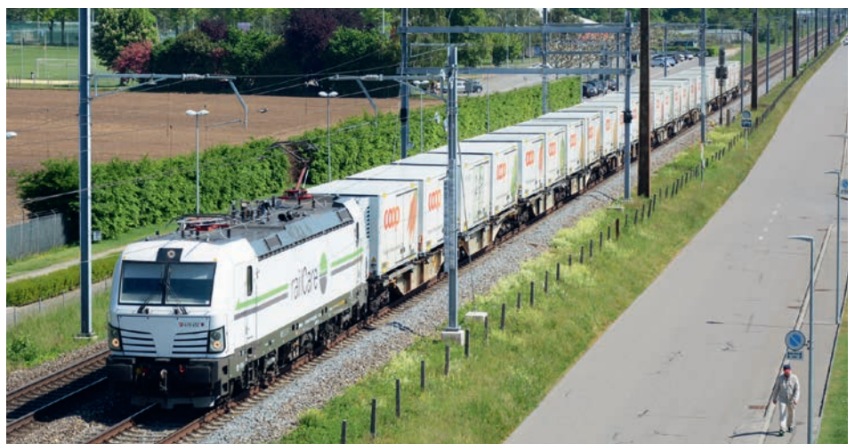
RLC-476 452 mit 25 Wechselbehältern auf 7 AAEC-Sggmrss als UKV-Zug 50848 Vufflens-la-Ville-Genève-La Praille eingangs Gland am 11.5.2018. Fotos: S. Frei
