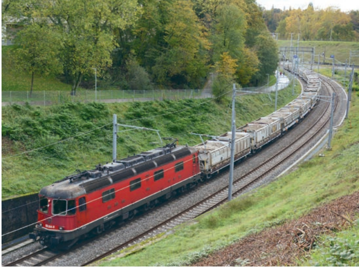
Re 620 044 mit Aushub von rund 1200 t brutto in Fans-u von VTG und SBBC als Ganzzug 68053 (Vernier-Meyrin Cargo-)Genève-La Praille-Onnens-Bonvillars im Rechtsverkehr der Ceva bei der Verzweigung Jonction kurz vor dem St-Jean-Tunnel am 6.11.2019.
