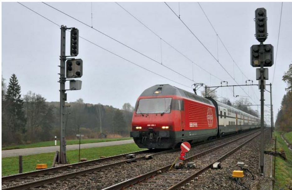
Oben: Ein IC Romanshorn – Brig fährt auf dem in Fahrtrichtung rechten Gleis am Einfahrtsignal Sulgen vorbei; das linke Gleis wird durch ein Haltsignal geschützt (Foto: Ch. Frauenknecht, 13. November 2013).
