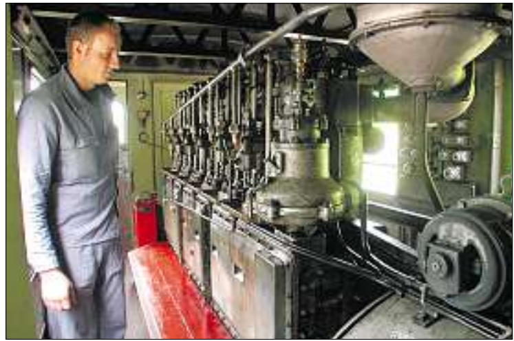
Historisch-technische Sensation aus der AB-Oldtimersammlung: betriebsfähiger Dieseltriebwagen mit Original-Sulzer-6-Zylindermotor von 1928!
